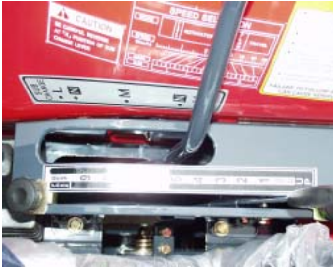
FIG.2-26 Range shift lever
